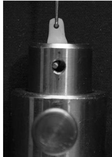
Figura 5. Ensaio de Tração.
