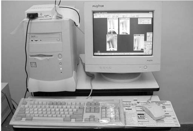
Figura 1. Sistema de radiografia digital direta acoplado ao computador.
