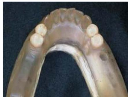
Fig. 3 - Modelo fotoelástico (Araldite GY279BR - Araltec).
