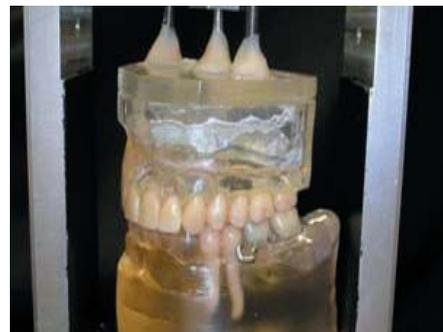
Fig. 9 - Pontos de aplicação de carga, fixados entre o 2º pré-molar e o 1º molar, sobre o modelo superior antagonista, estando este articulado em máxima intercuspidação com o modelo fotoelástico.
