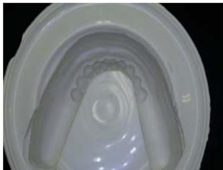
Fig. 2 - Molde obtido com borracha de Silicone BX3-8001 para confecção do modelo fotoelástico.
