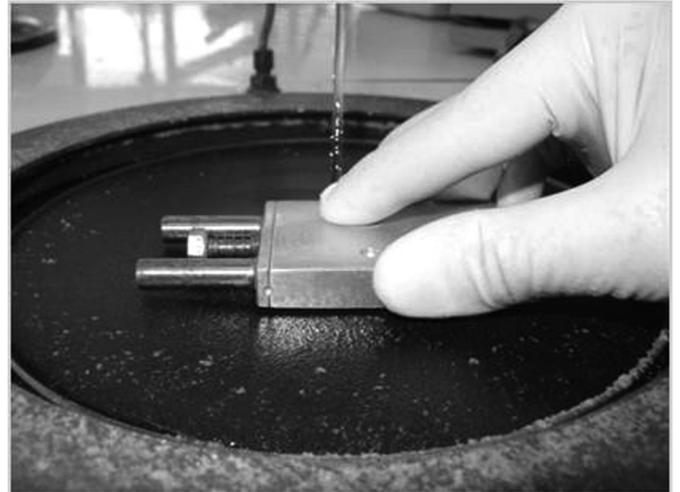
Figura 3. Dispositivo guia para acabamento em espessura.
